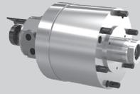
Hydraulik-Vollspannzylinder mit eingebauten Sicherheitsventilen und Kolbenhubkontrolle. Zentrale Durchgangsbohrung für Luft oder Kühlmittel ( $p_{max} = 70 \text{ bar}$ )
