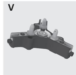
Zunächst wird die passende Aufsatzbacke (1 bis 6) anhand des Kopfkreisdurchmessers [ $d_a$ ] des zu bearbeitenden Zahnrades ausgewählt. Pro Backengröße kann jeweils ein Durchmesserbereich von insgesamt 20 mm mit zwei verschiedenen Spannbolzen (Typ A und Typ B) abgedeckt werden. Die Aufsatzbacken werden im Satz inklusive einem geraden Key Lock Einsatz geliefert.
