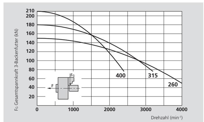
Die Daten der Diagramme beziehen sich auf 3-Backenfutter, die nach Bedienungsanleitung frisch gewartet und mit SMW-AUTOBLOK-Fett K67 geschmiert sind. Die statischen und dynamischen Spannkraften sind mit weichen Standard-Aufsatzbacken gemessen, die nicht radial über den Futterkörper überstehen.
