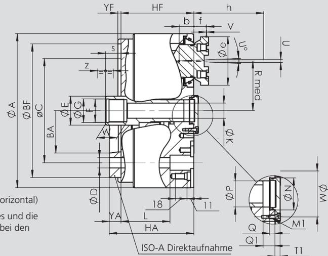
Grundbacken in mittlerer Hubposition (horizontal)
