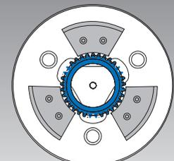
Spannfinger werden nicht montiert
